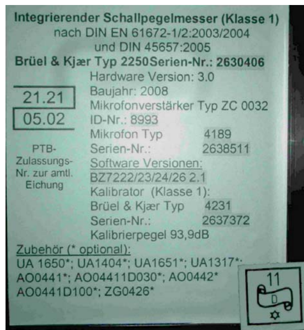
Abb.9 +10 Bauartzulassung und Eichschild eines Brüel & Kjær Schallanalysators 2250
