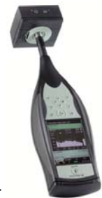
Abb.8 Brüel & Kjær Schallkalibrator 4231, aufgesetzt
